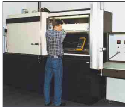
ESSAIS CLIMATIQUES -50 °C + 200 °C. AVEC 0 À 100 % D'HUMIDITÉ RELATIVE.
