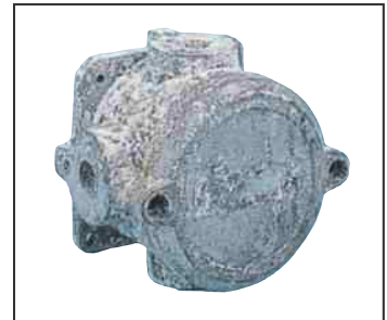
CORROSION SUR PRODUIT NON TRAITÉ.
