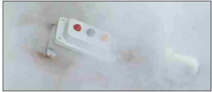
ESSAI DE CORROSION AU BROUILLARD SALIN DANS NOS LABORATOIRES.
